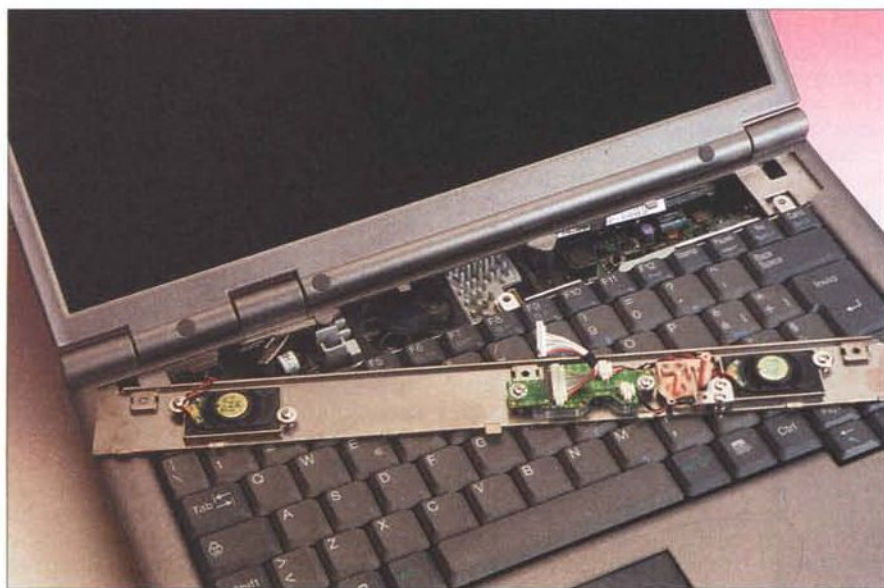
La possibilità di accedere al processore è garantita da uno sportellino sulla sommità della tastiera.
